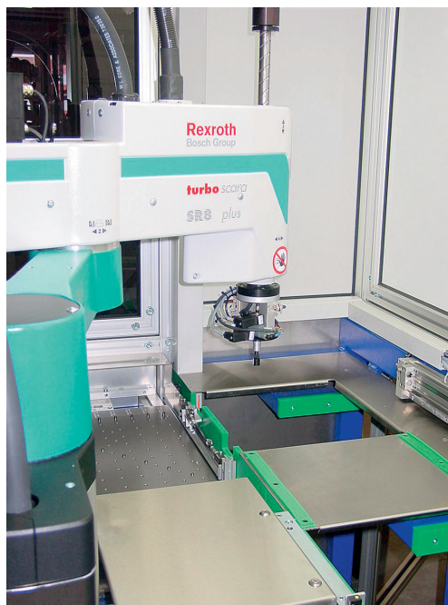
Vision-Komponenten in einer Verpackungslinie für Münzen (links) und Roboter mit Greifer über der Tablettaufnahme.
