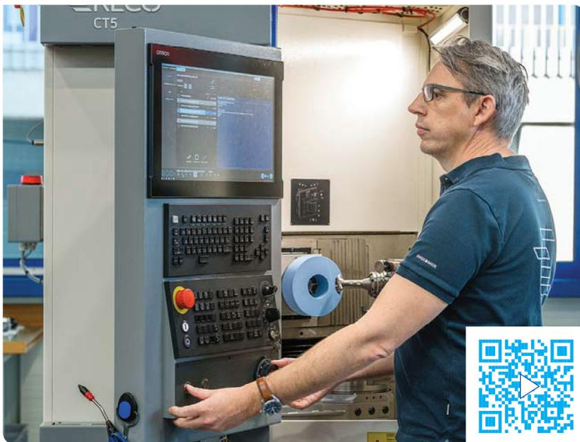
**Machine CNC multifonction à 6 axes, dont 5 simultanés, destinée à la finition et la préparation de surfaces complexes.**
