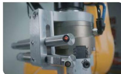
En haut, la réflexion de lumière pour le capteur iORS et les courants de Foucault, en bas.
