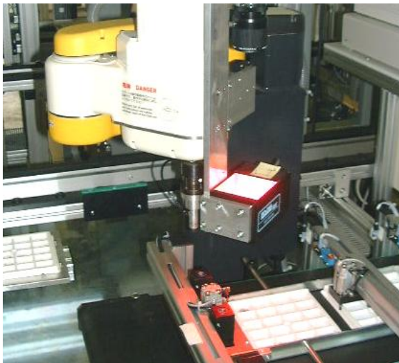
Le système de vision permet une haute précision de saisie.
