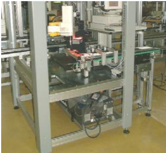
La caméra et l'éclairage sont fixés directement sur le bras du robot.
