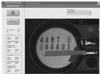
Systeme de vision pour le contrôle d'impression sur des batteries dans l'industrie médicale
