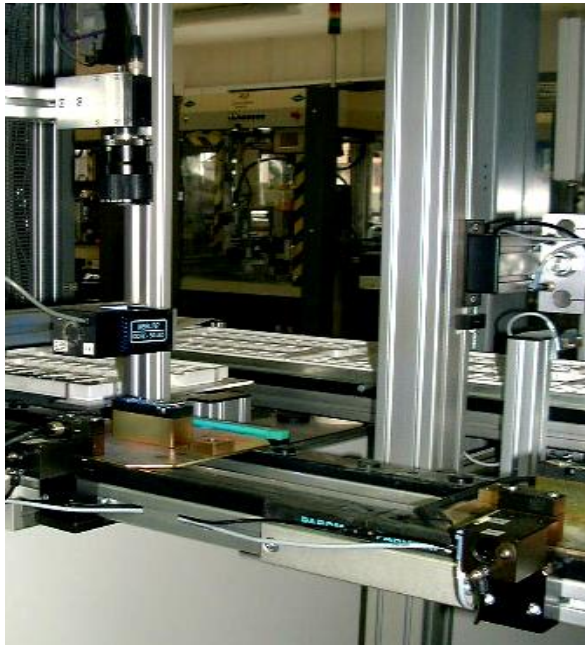
Caméra et éclairage fixés au dessus du ruban transporteur.
